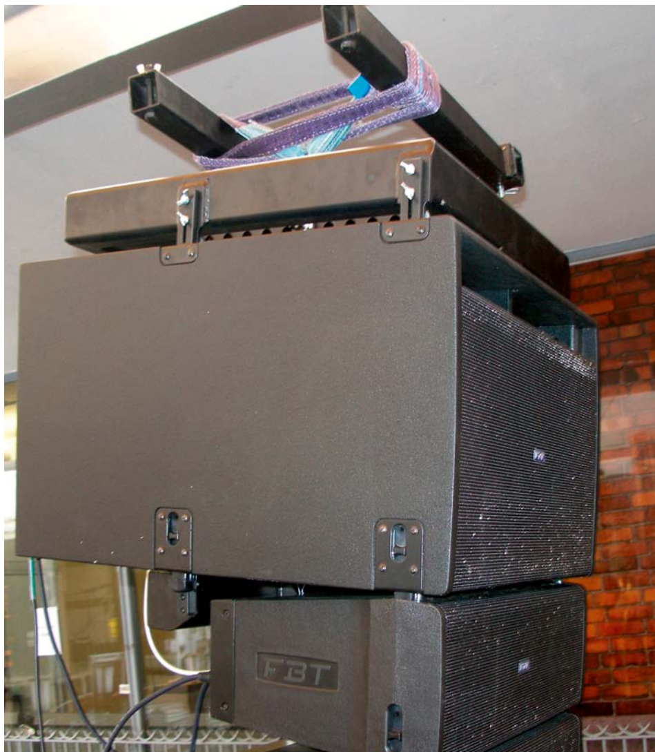
Mid-bass Mitus 212FSA, wyposażony w dwa neodymowe głośniki B&C o średnicy 12”, jest przystosowany do podwieszania.
