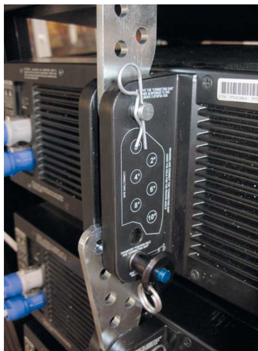
... zaś z tyłu na łączniku kątowym można ustawić moduły w skoku co 2 stopnie, od 0 stopni do 10 stopni.
