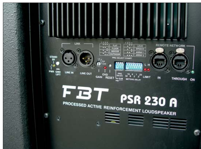
Na panelu tylnym mamy gniazda pozwalające na podłączenie i wyprowadzenie sygnału, jak również gniazda sieciowe pozwalające na sterowanie via sieć. Mikroprzełącznikami zmienia się ustawienia korekcji zestawu.
