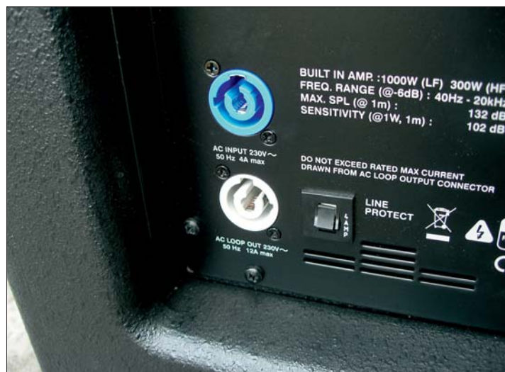
Dwa gniazda typu Powercon pozwalają na pewne podłączenie zasilania oraz „przesłanie” go do następnego zestawu, co jest przydatne, gdy pracują one zestawione w większej grupie.
